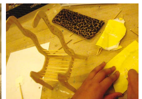
Bambuspinner kappes og pusses før de festes i hullene med lim.
